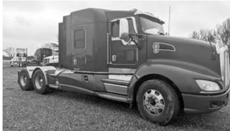
'14 KW T660, ISX, 18 spd., auto., 46R, 4.11 ratio.
