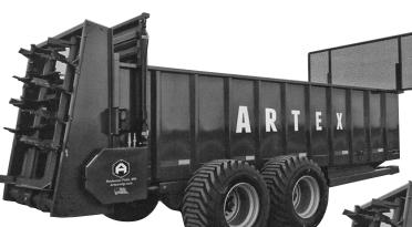
**SB600** LENGTH 22' **WIDTH 5'6"** WALL HEIGHT 4' CAPACITY 600 CU. FT. **HORSEPOWER 150**
